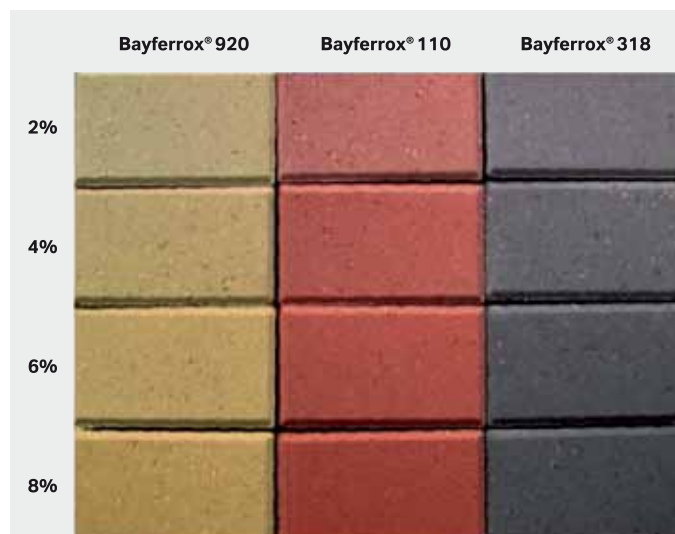
A influência do nível de pigmentação na tonalidade final
