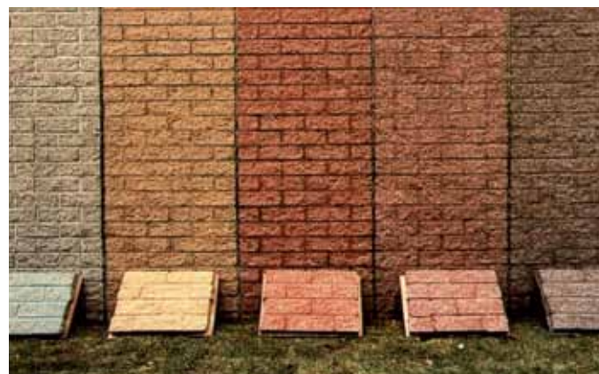
Tijolos de concreto (amostra não desgastada pelas condições climáticas no primeiro plano). Início do desgaste: 1970, foto: 1995.
