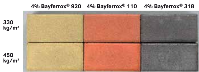
Influência do conteúdo de cimento na cor do concreto
